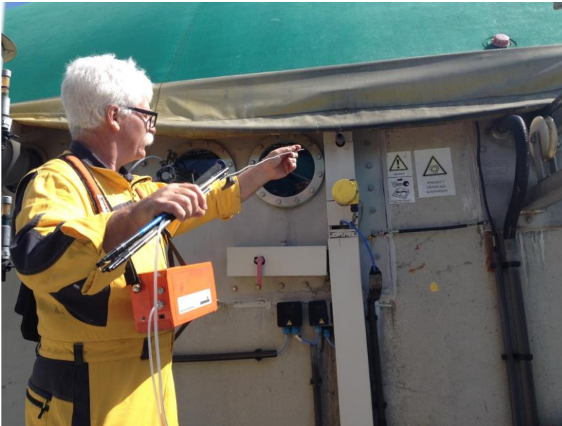
Abbildung 4 Oester Messtechnik GmbH beim Messen der Methankonzentrationen an den Schaugläsern eines Fermenters mit einem Flammenionisationsdetektor.
