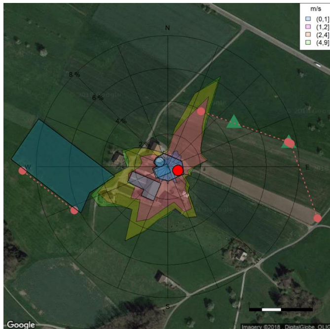
Abbildung 1. Luftbild der Biogasanlage CH-01. Eingezeichnet in hellroten Kreisen sind die Standorte der GasFinder mit deren Retroreflektoren. Einer befindet sich im Südwesten der Anlage, zwei weitere im Nordosten und Osten der Anlage. Die gestrichelten Linien zeigen die Messpfade an. In grünen Dreiecken sind die beiden Ultraschallanemometer eingezeichnet, wobei Sonic1 im Nordosten und Sonic2 im Ostrnordosten steht. In einem blauen Overlay sind die Methanquellen Weide, Stall und Biogasanlage eingezeichnet. Die Biogasanlage ist weiter unterteilt in Festlager, Gül-lager und in Rot der Nachgärer. Zusätzlich ist Verteilung der vor Ort gemessenen Windrichtung (10° Intervalle) und Windgeschwindigkeit (Einteilung: 0-1 m/s, 1-2 m/s, 2-4 m/s und 4-9 m/s) eingezeichnet. (Quelle: HAFL)
