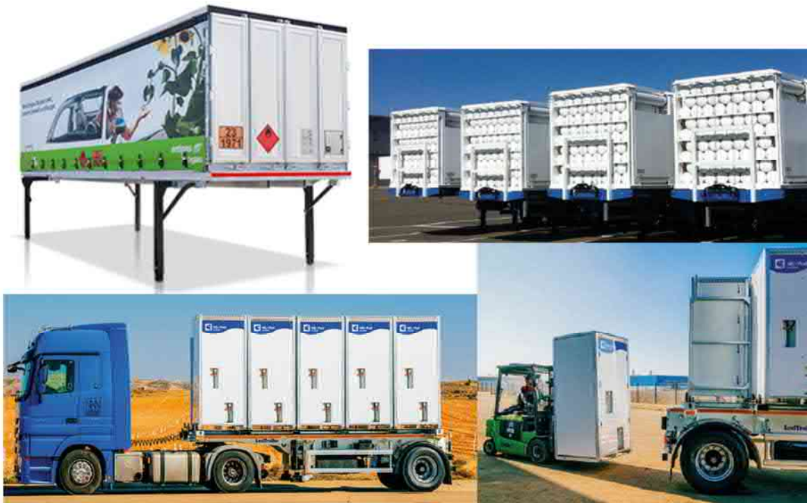
Bilder: mögliche CNG-Transport-Systeme unterschiedlicher Hersteller für den Transport von Biogas
